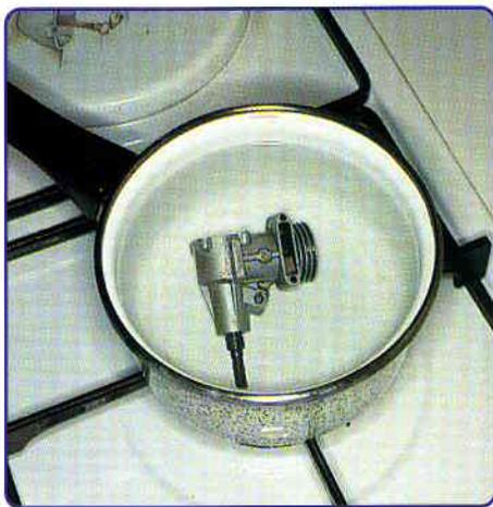
**Si la chemise ne veut pas sortir, une seule solution : chauffer l'ensemble dans une casserole d'eau bouillante.**
